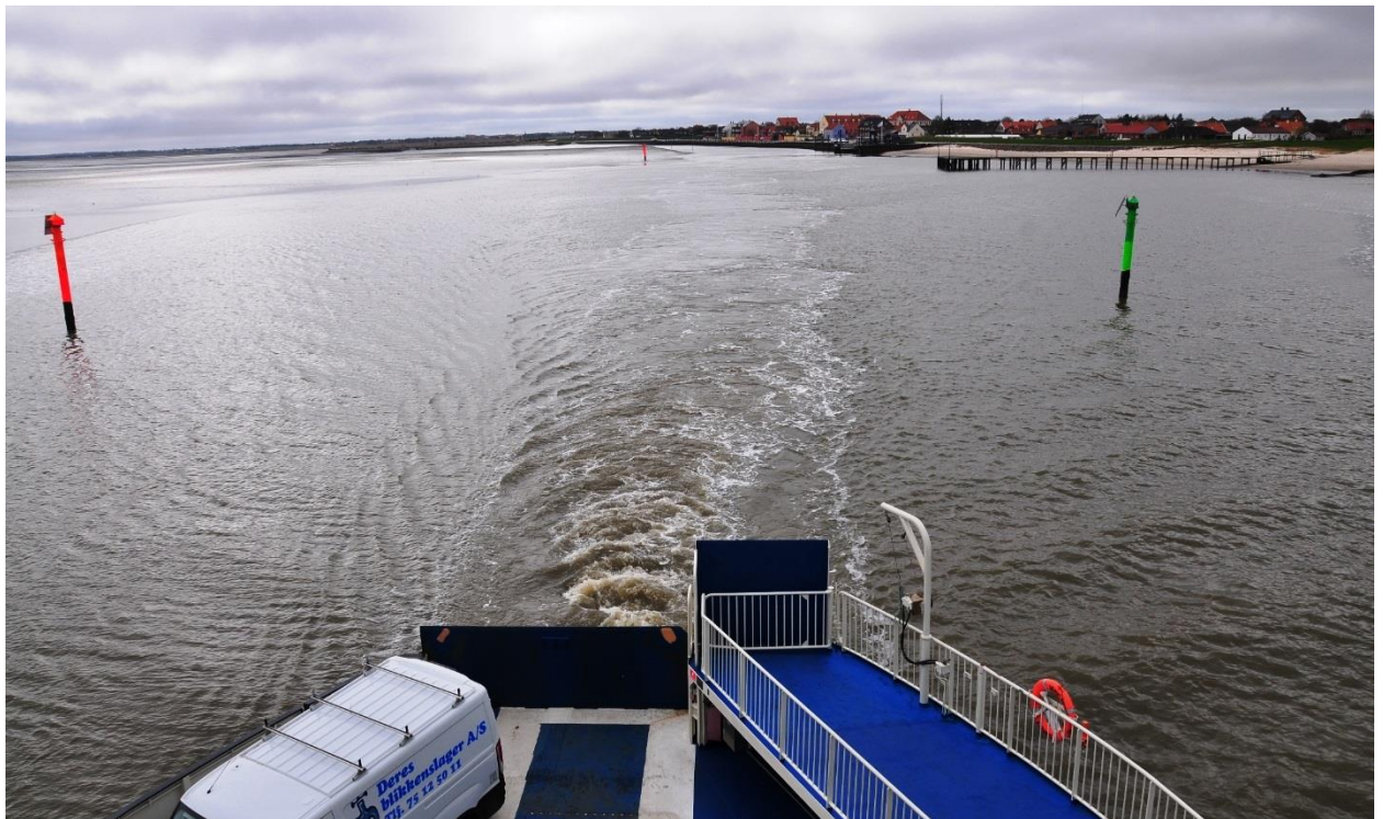
Figur A8: Passage af 1. bøjepar 3. april 2017 kl. 14:16:00 Bemærk kølvandet fra propellen. Da det var lavvande arbejdede maskineri ekstra hårdt og skibet sejlede kun ca. 6 knob.
