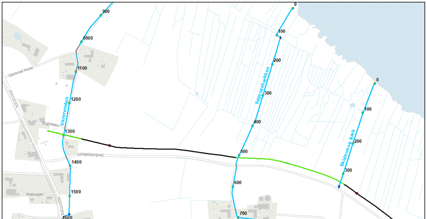
Fig. 2. Krydsning under Varerenden, Søjordsbækken og Skideneng Bæk med 60 kV kabelanlæg. Grønt tracé er styret underboring, sort tracé er nedgravning. Nummeringen angiver vandløbenes stationering i meter.
